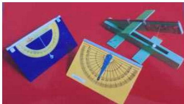
Figura 11. Modelo de clinómetro.
